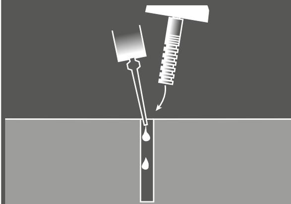
3. Nach der Klebstofftrocknung ist der Poller belastbar. Wenn der Poller nicht dauerhaft verklebt wird, schützt ein Gewindestift mit Innensechskant den Bodenanker während kurzzeitiger Demontage vor Verschmutzung.
