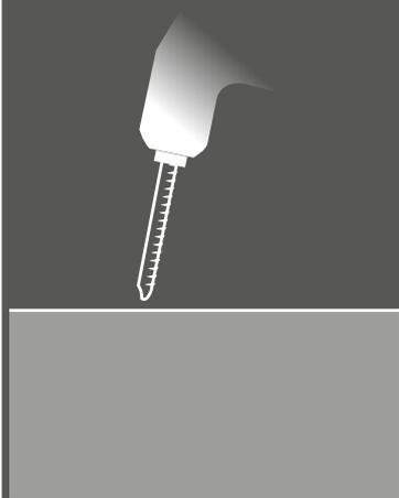
2. Poller mit Bodenanker mit Zwei-Komponenten-Kleber einsetzen - vollständig aushärten lassen!
